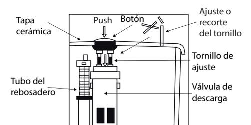
Ajuste los tornillos o corte si es necesario, verifique la altura entre el botón y la válvula de descarga, antes de cortar los tornillos. **NOTA:** El tornillo de ajuste cuenta con dos formas de colocación para el botón (Verifique el modelo).
