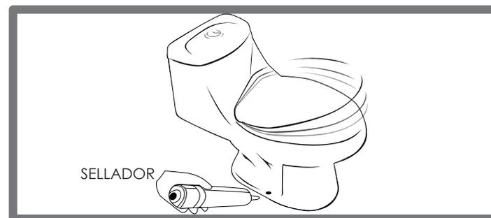
**5)** Instale las tuercas junto con los tornillos y apriételos (no apriete demasiado fuerte o romperá la taza). Conecte el suministro de agua a la válvula de admisión (incluida).
