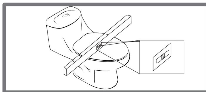
**3)** Levante la taza y cuidadosamente coloque sobre la salida del tubo de desagüe en su posición normal, quedando los tornillos dentro de la base, asegúrese que esté firme y alineada. Presione hacia abajo o siéntese sobre la taza de frente a la pared. Use un ligero movimiento para empotrar la taza en el cuello de cera, no mueva la taza bruscamente o se deformará la cera.
