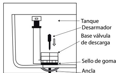
Ajuste la base de la válvula con el sello de goma en la perforación, ajuste el ancla en el agujero de salida. Apriete el tornillo utilizando un desarmador de cruz, ejerciendo fuerza en el tornillo hasta tener un sello entre el tanque y la base de la válvula, verifique que el sello de goma ajuste perfectamente en la perforación.
