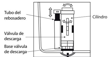
Coloque el cilindro o válvula de descarga en su base, gire a la izquierda o a la derecha y ajuste. Verifique el tubo del rebosadero que se encuentre por encima del nivel de agua.
