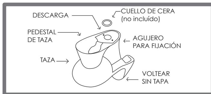
**1)** Limpie el área de instalación del inodoro y verifique que las distancias sean las correctas (305 mm del muro al desagüe), coloque las pijas de sujeción.
