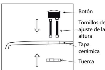
Gire la tuerca del botón, e inserte el botón desde arriba de la tapa del tanque en el agujero, coloque la tuerca del botón desde el interior de la tapa del tanque y ajuste.
