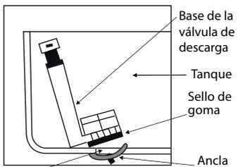
Coloque la base de la válvula en la perforación de desagüe del tanque, inclinando la base y colocando el ancla dentro de la perforación y ajuste.
