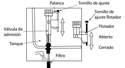
Ajuste el nivel de agua del tanque utilizando el tornillo del flotador, gire el tornillo a la derecha (nivel alto), gire el tornillo a la izquierda (nivel bajo). La palanca, el tornillo y el flotador tienen que quedar libres, para su accionamiento hacia arriba (abierto) y hacia abajo (cerrado).
