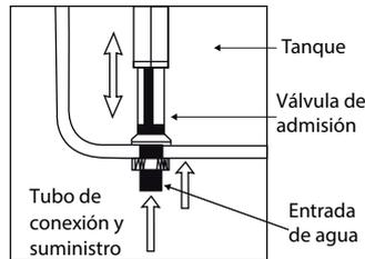
Inserte la válvula de admisión, coloque el sello de goma en la parte inferior, ajuste la tuerca hexagonal y apriete. La válvula de admisión se puede ajustar hacia arriba o hacia abajo, gire a la derecha, ajuste la altura, gire a la izquierda y coloque el seguro.
