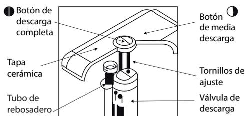
Ajuste la dirección del botón con la tapa del tanque y la válvula de descarga. Verifique que los tornillos al colocar la tapa de cerámica no abran la válvula de descarga, para evitar fugas.
