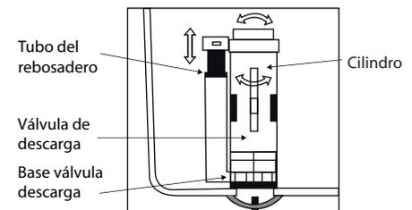
Coloque el cilindro o válvula de descarga en su base, gire a la izquierda o derecha y ajuste. Verifique el tubo del rebosadero que se encuentre por encima del nivel de agua.
