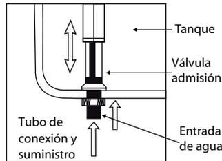
Inserte la válvula de admisión, coloque la goma de sello en la parte inferior, ajuste la tuerca hexagonal y apriete. La válvula de admisión se puede ajustar hacia arriba o hacia abajo, gire a la derecha, ajuste la altura, gire a la izquierda y coloque el seguro.
