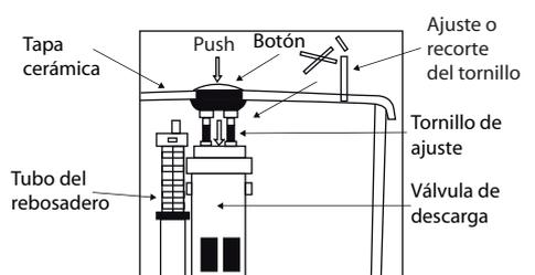
Ajuste los tornillos o corte si es necesario, verifique la altura entre el botón y la válvula de descarga, antes de cortar los tornillos. **NOTA:** El tornillo de ajuste cuenta con dos formas de colocación para el botón (Verifique el modelo).
